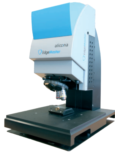
Vollautomatische Messung von Radien, Winkeln, Korbbogenform und Fasen in der Produktion
