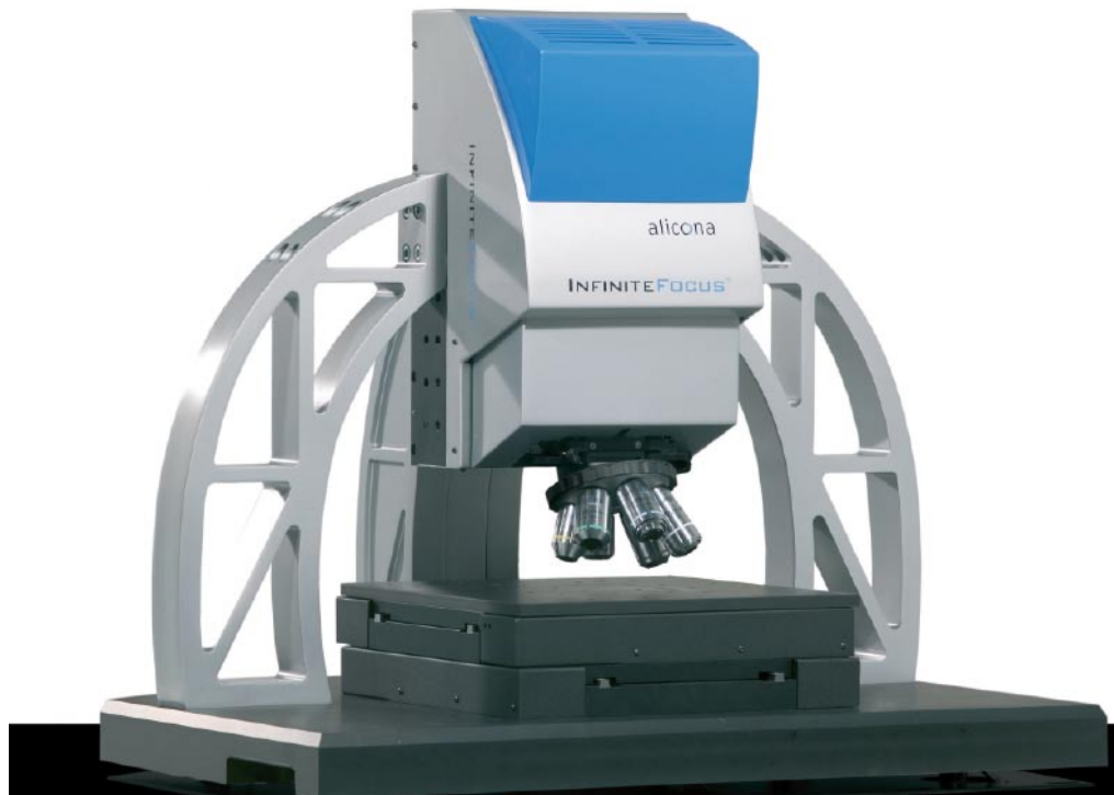
Hochauflösendes optisches 3D Oberflächenmesssystem InfiniteFocus zur Form- und Rauheitsmessung im Labor und in der Produktion. Schneidkanten werden mit einem Radius ab 2\mu\text{m} , Winkel bis zu einer minimalen Größe von 20^\circ gemessen.
