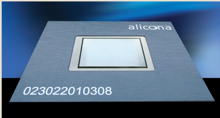
Bild 5. Einer der Maßnahmen, die optische Messtechnik international zu professionalisieren, ist das von Alicona entwickelte Rauheitsnormal. Mit diesem Prüfstandard ist die Genauigkeit für sämtliche ISO klassifizierte optische Messverfahren nachweisbar und steht somit der gesamten Branche zur Verfügung
