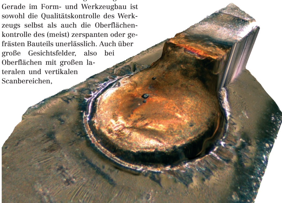
3D Darstellung eines Schweißpunktes in Echtfarbandarstellung
