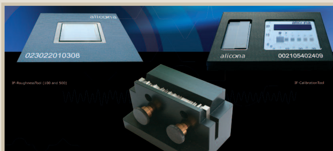
Bild 3. Messnormale für taktile und optische Messungen stellen die Rückführbarkeit der Messergebnisse sicher
